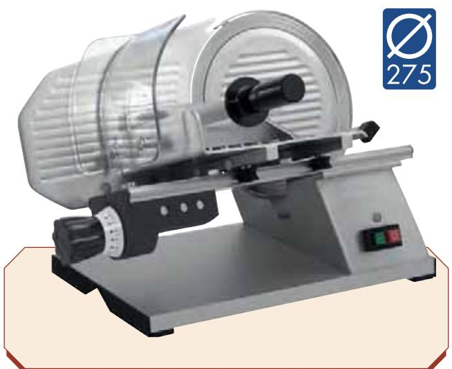
**N SNIJMACHINE - basis vervaardigd van geanodiseerd gegoten aluminium met extra groot afzetplateau, tandwiel aangedreven en daardoor ook geschikt voor o.a. kaas., extra gehard holgeslepen stalen mes met groeven voor optimale snijkwaliteit, traploos instelbare snijdikte 0-16 mm, meer ruimte tussen het mes en de motor, slede en mesbeschermpaat eenvoudig te verwijderen voor gemakkelijke reiniging**
