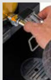
Anschließend den Adapter nach unten festziehen. Durch das Nach-Vorne-Drücken des unteren Edelstahlbügels mit Hilfe des Glases, wird der Hebel des Zapfhahns betätigt und das Getränk fließt völlig handkontaktlos in das Glas.
